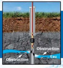
Avec nos équipements de fracturation, l'eau propre est injectée à de grandes pressions et un fort débit afin d'enlever les sédiments qui obstruent les fractures.
