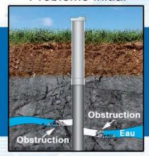
La zone aquifère est obstruée par des sédiments de sable et de silt qui empêchent l'eau de s'infiltrer librement dans le puits.
